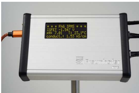
Multisensorsystem Sensorsteuerung zur Aufnahme und Anzeige von Messdaten. © Fraunhofer IPMS
