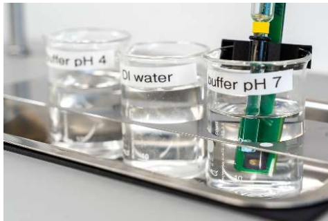
Beispielhafte Messanordnung mit ISFET, Leitfähigkeitssensor und Referenzelektrode © Fraunhofer IPMS
