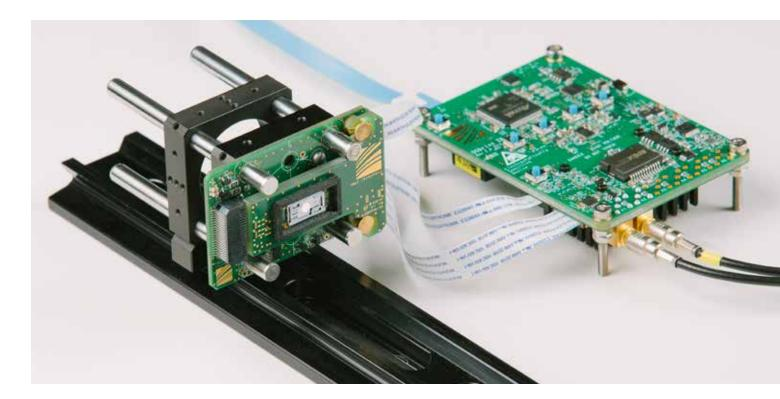
Mit dem ResoLin-Evaluation-Kit »QSDrive Scan Kit« bietet das Fraunhofer IPMS seinen Kunden ab sofort die Möglichkeit, kostenschonend und flexibel statisch auslenkbare MEMS-Scannerspiegel für Anwendungen zu erproben, die mit den verbreiteten resonant schwingenden Mikroscannern bislang nicht zufriedenstellend bedient werden konnten.
