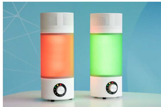
Wohlfühlampel zur optischen Darstellung des Lärmpegels. © Fraunhofer IPMS
